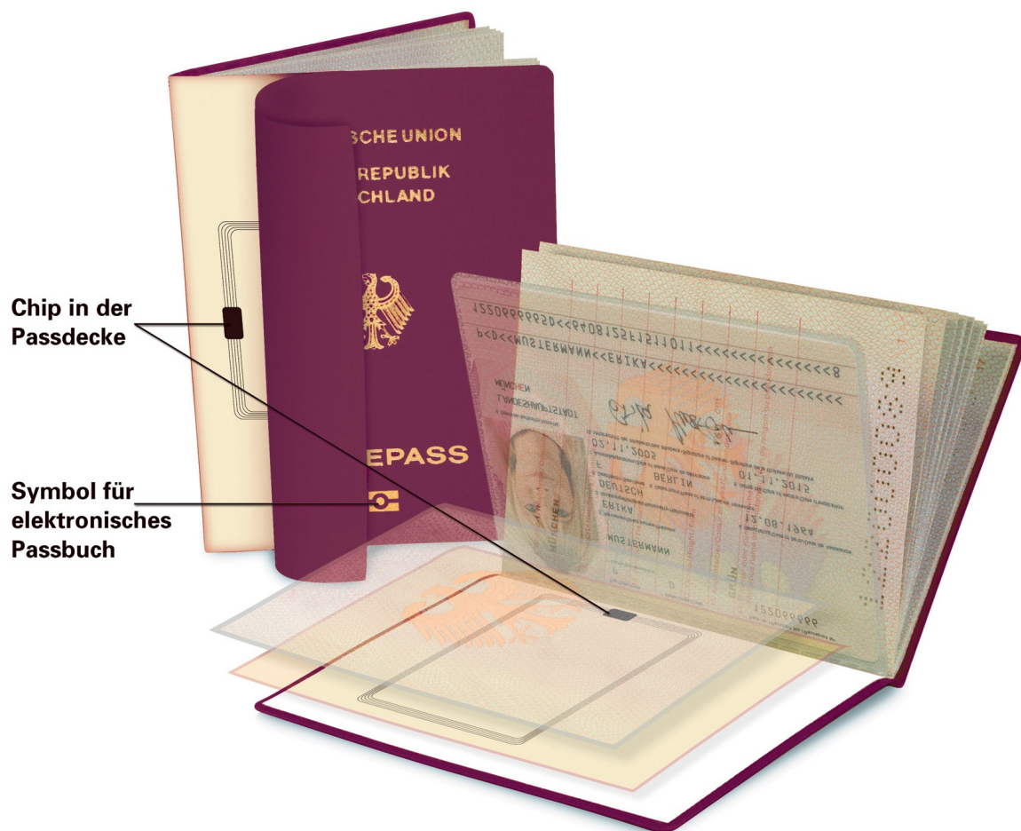
Abbildung 3: Schematische Darstellung des Aufbaus des deutschen elektronischen Reisepasses. Quelle: Bundesministerium des Innern
